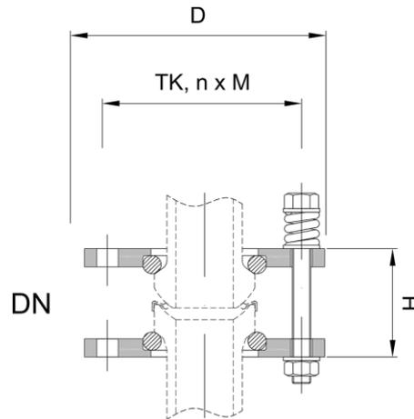
Flanschverbindung, Typ CS...-K
