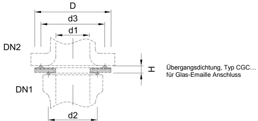
Übergangsdichtungen werden zwischengespannt und können zum Anschluss an Flansche nach EN 1092-1 (alle Nennweiten) und ANSI 150 (außer Nennweite 25) verwendet werden. Die entsprechende Anschlussverbindung vom Glasflansch finden Sie in diesem Kapitel.
