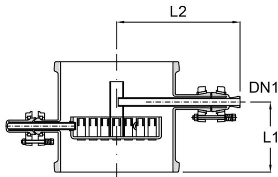
Tüllenverteiler mit Feed ACDNF ...-P
