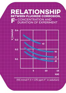
a) no additive b) 100 mg/l  $\mathrm{SiO}_2$  c) 200 mg/l  $\mathrm{SiO}_2$  d) 400 mg/l  $\mathrm{SiO}_2$  pH = 1 | 80 °C
